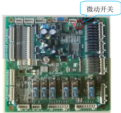
图 8.微动开关位置示意图
